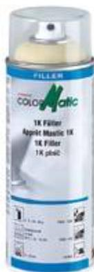
ColorMatic 1K Füller ist ein moderner 1K Acrylfüller mit sehr hoher Füll- und Deckkraft. Sehr gut zum Füllen von leichten Kratzern und kleinen Unebenheiten auf geschliffenen Untergründen. Haftet gut auf Polyesterspachtel, Kunststoff und Metall. Sehr glatter Verlauf, Naß-in-Naß überlackierbar, leicht schleifbar.
