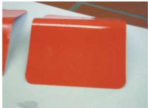
**Abb.:** links: nativer Baumharzextrakt auf einem Lackprüfblech (OEM-Qualität), angetrocknet bei 40°C
